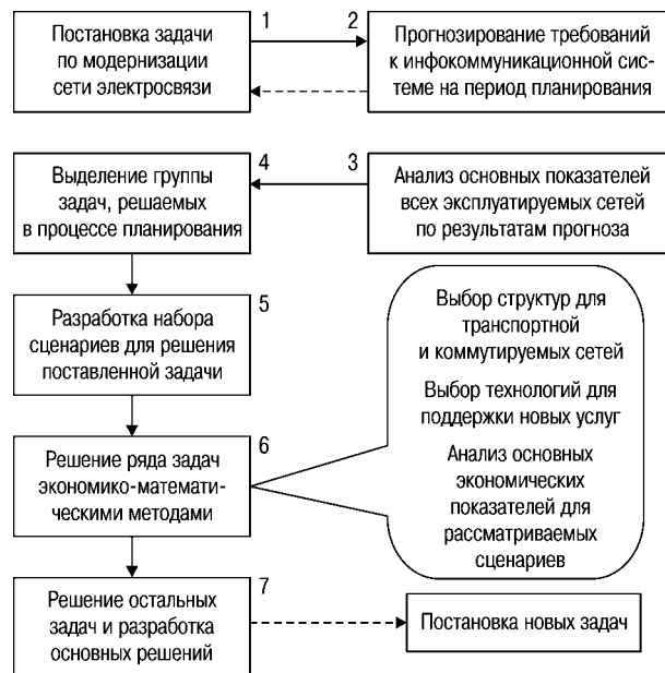
Рисунок 1.38 Алгоритм планирования инфокоммуникационной системы
